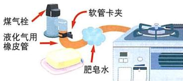
※要检查胶皮管是否漏气，涂抹肥皂水看是否冒泡即可知道。（冒泡的话，请立即更换新的胶皮管。）检查后请擦拭干净。
